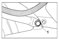
1. Brake torque rod bolt
